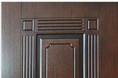
Фрезерованная МДФ панель покрытая шпоном. Место фрезеровки не покрыто шпоном. Окрашено в цвет основного фона.
